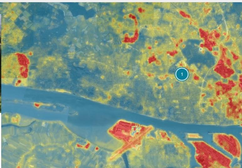
Abb. 10: Ausschnitt der, über ArcGIS Enterprise von CoKIMAx bereitgestellten, Darstellung der, durch UrbanGreenEye berechneten, Oberflächentemperatur, mitsamt positivem Fallbeispiel einer Fassadenbegrünung in Hamburg-Bahrenfeld [Quelle: CoKLIMAx];
